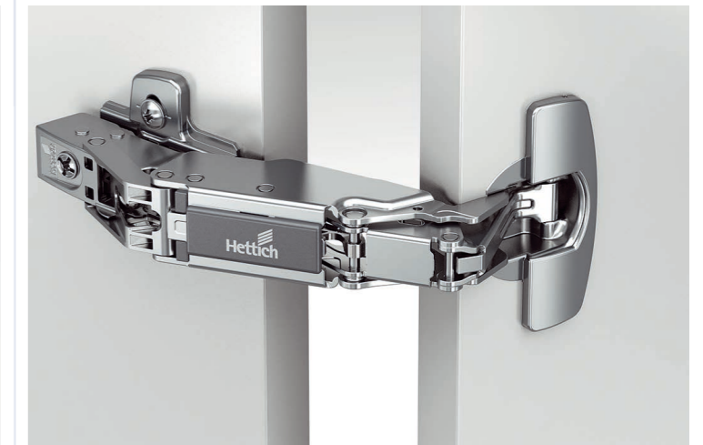
Петля накладная с широким углом открывания в дизайне Intermat (угол открывания 165°, угол корпуса 90°)
